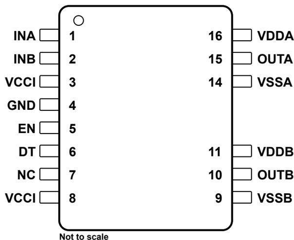
**Figure 4-1. Pin Diagram**
