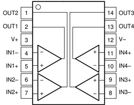
**Figure 4-1. Pin Diagram**
