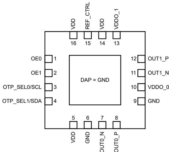
**Figure 4-1. Pin Diagram**
