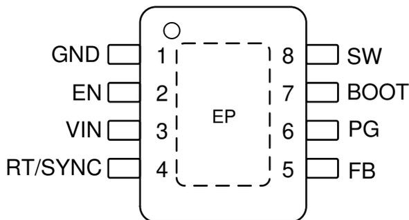
**Figure 4-1. Pin Diagram**
