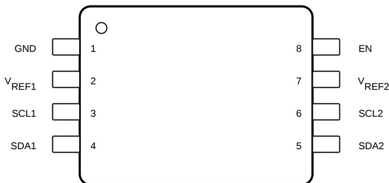
**Figure 4-1. Pin Diagram**
