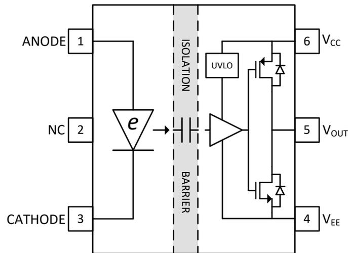
**Figure 4-1. Pin Diagram**
