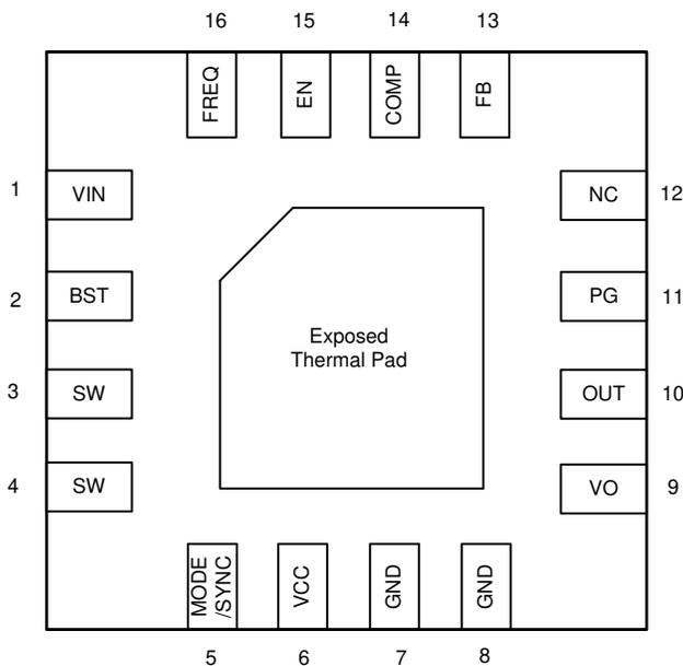
**Figure 4-1. Pin Diagram**
