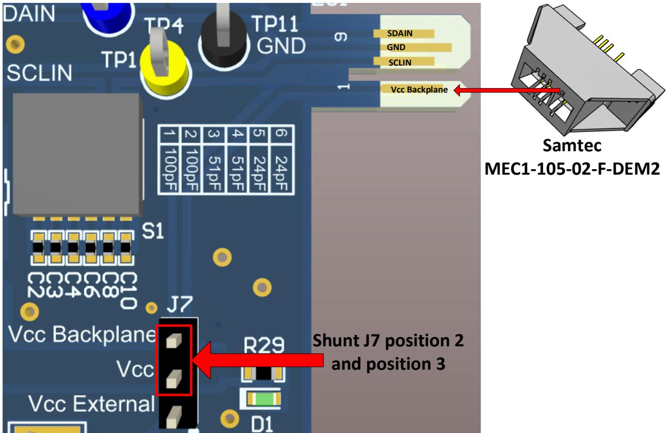
Figure 3.  $V_{CC}$  Backplane Select
