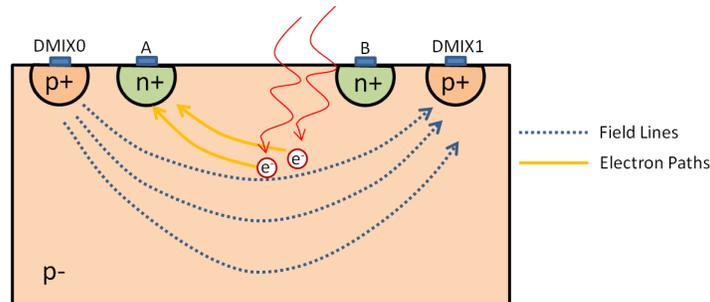
**Figure 3-9. Pixel Structure**
