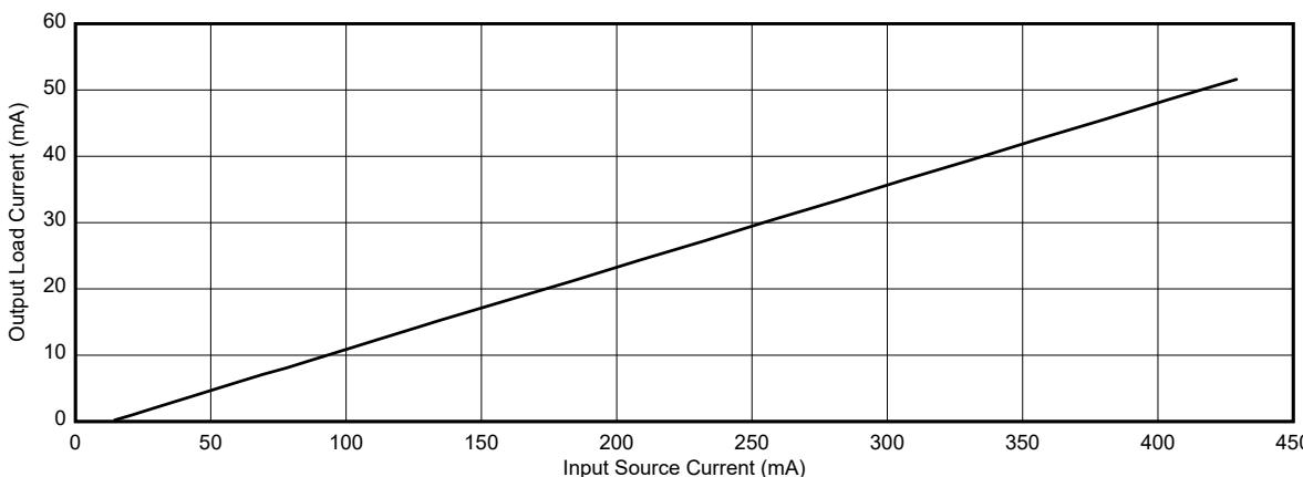
根據建構電路的測量結果，輸入電流比輸出負載電流大八倍以上。對於供應電流 500mA 的標準 USB 2.0 連接埠， $\pm 15V$  電源的最大輸出電流約為 60mA。
