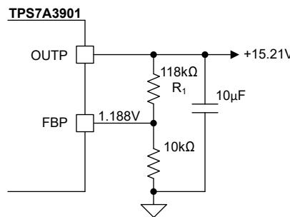
從 15V 的輸出和從 FBP 到接地的  $10k\Omega$  電阻開始，頂部電阻器可以透過以下計算得出：
