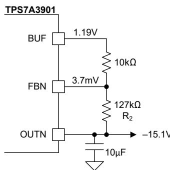
從  $-15V$  的輸出及從 BUF 至 FBN 的  $10k\Omega$  電阻器開始，底部電阻器可以透過以下計算得出：
