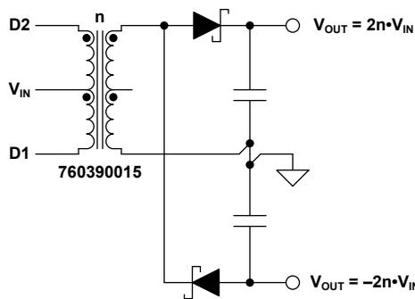
SN6505B 會從切換 D1 和 D2 建立切換週期。這些週期會推動或拉電流經過中心抽頭變壓器。切換週期交替，以設定超出整流器二極體的正負電壓輸出。下圖顯示切換週期期間透過輸出的電流路徑。
