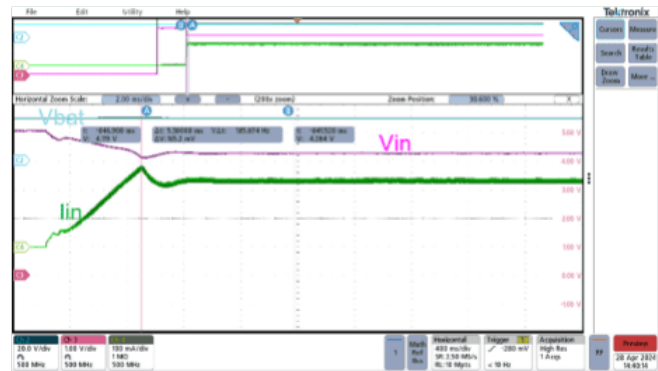
그림 4. 1m USB 케이블을 사용하여 5V, 2A 소스로 충전 시의 입력 동적 전원 관리. 출처: 텍사스 인스트루먼트
