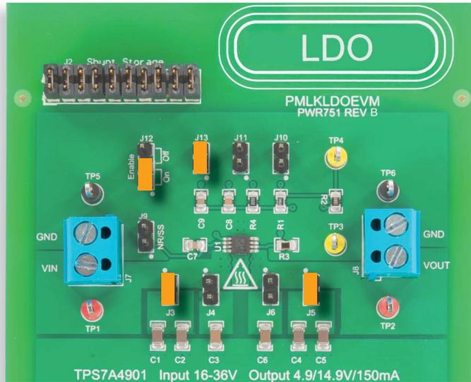
Abbildung 7: TPS7A4901-LDO-Platine: Jumperkonfiguration für Prüfung 2
