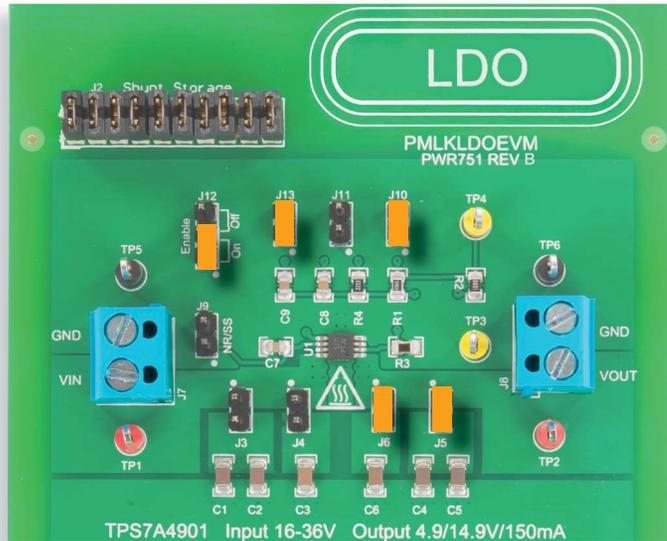
Abbildung 6: TPS7A4901-LDO-Platine: Jumperkonfiguration für Prüfung 1
