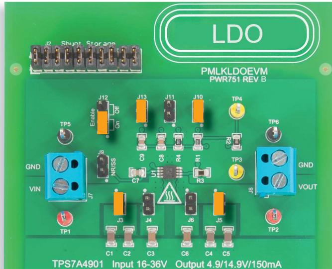
Abbildung 7: TPS7A4901-LDO-Platine: Jumperkonfiguration für Prüfung 2
