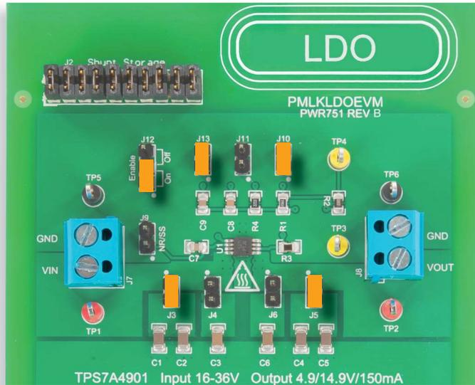
Abbildung 6: TPS7A4901-LDO-Platine: Jumperkonfiguration für Prüfung 1
