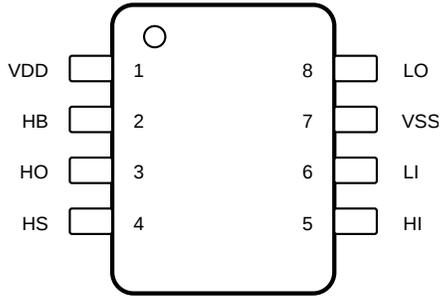
图 4-1. D Package 8-Pin SOIC Top View
