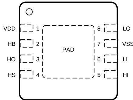
图 4-3. DRM Package 8-Pin VSON Top View
