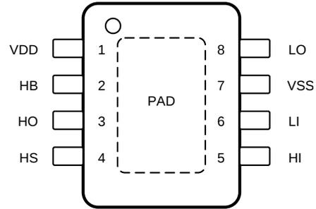
图 4-2. DDA Package 8-Pin SO PowerPAD Top View
