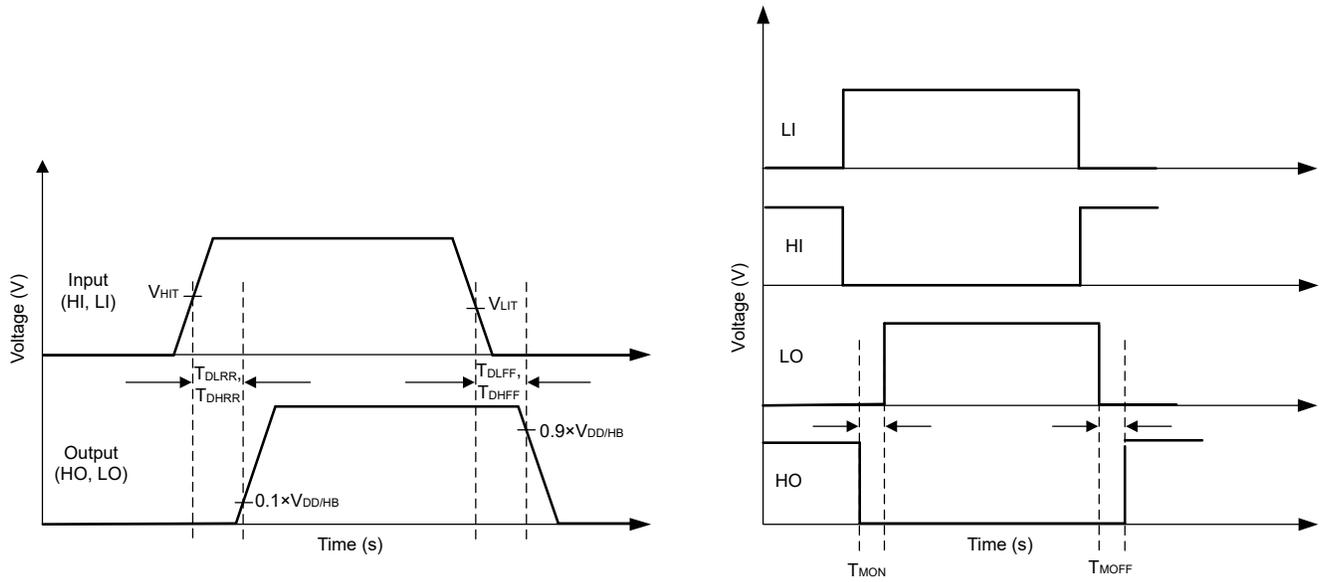
图 5-1. Timing Diagrams
