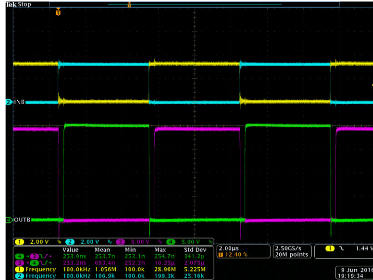
图 8-5. INA/B 和 OUTA/B 的台架测试波形
