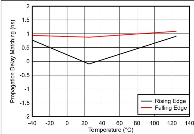
图 5-16. 传播延迟匹配 (t<sub>DM</sub>) 与温度之间的关系
