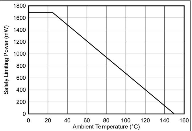
图 5-3. 安全相关限制功率的热降额曲线
