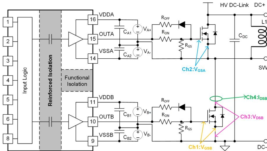
图 8-5. 具有 SiC MOSFET 开关的基准测试电路
