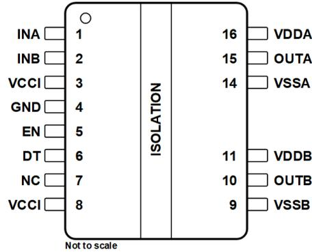
图 4-1. DWK 封装，14 引脚 SOIC (顶视图)
