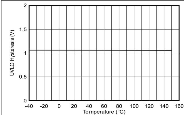
图 5-22. VDD 17V UVLO 迟滞与温度间的关系
