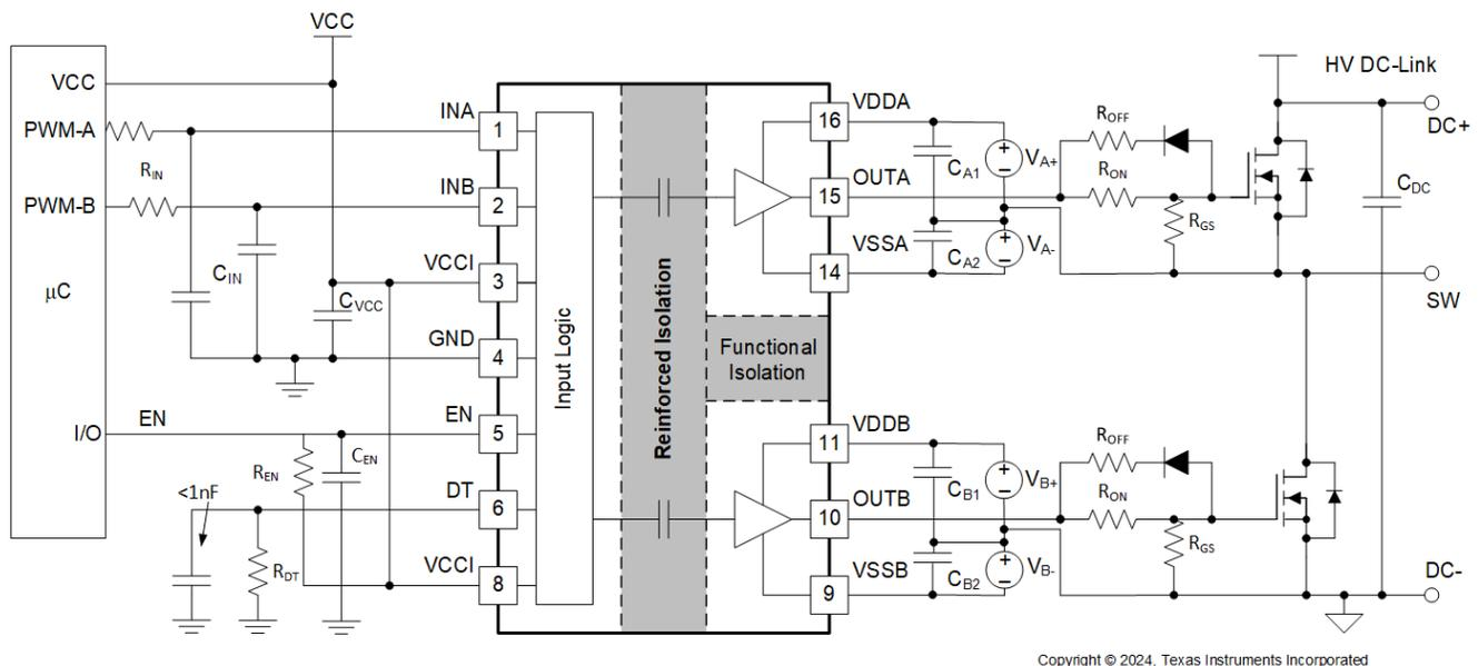
图 8-1. 使用双电源的典型应用原理图
