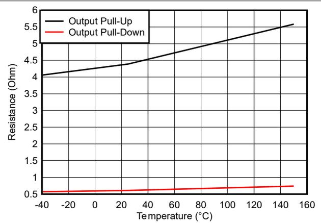
图 5-11. 输出电阻与温度之间的关系
