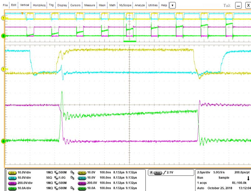
图 8-6. SiC MOSFET 开关波形
