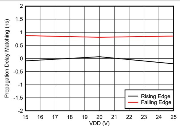
图 5-15. 传播延迟匹配 (t<sub>DM</sub>) 与 VDD 之间的关系
