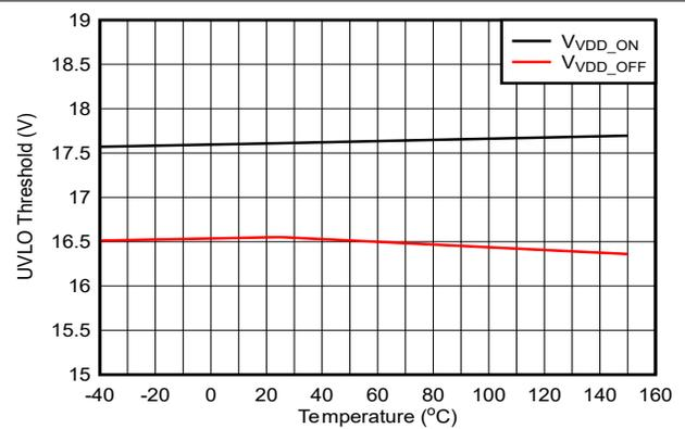
图 5-21. VDD 17V UVLO 阈值与温度间的关系
