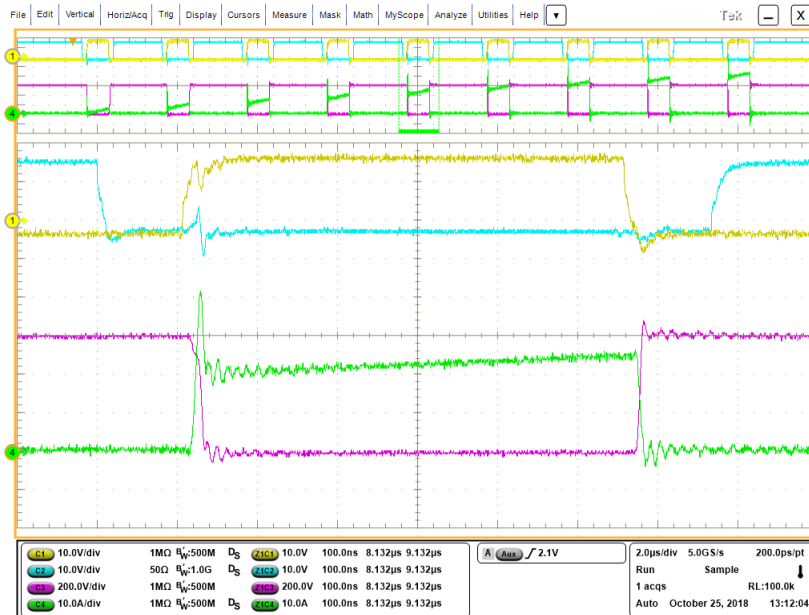
图 8-6. SiC MOSFET 开关波形
