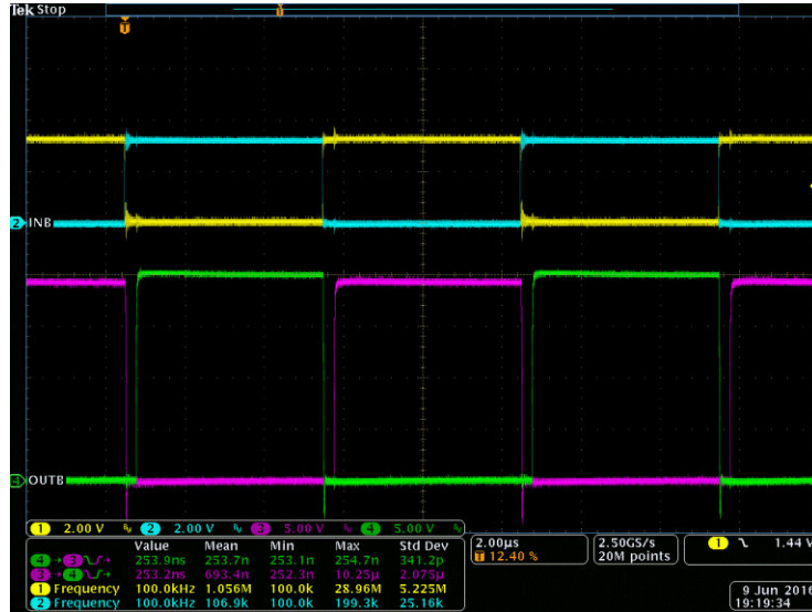
图 8-5. INA/B 和 OUTA/B 的台架测试波形
