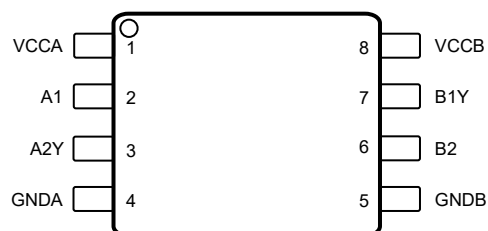
图 4-3. TXGx021DDF 8 引脚 SOT 和 TXGx021D 8 引脚 SOIC ( 顶视图 )
