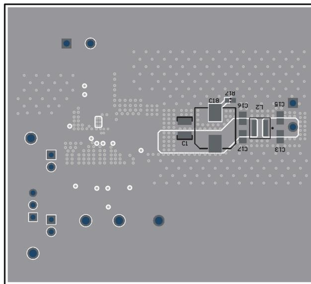
图 7-10. TPSM843521 底层布局示例
