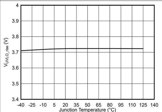
图 5-6.  $V_{IN}$  UVLO 上升阈值与结温间的关系
