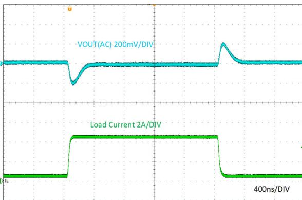
图 7-6. 负载瞬态响应, 0.5A 至 4.5A, 压摆率 = 0.8A/ $\mu S$
