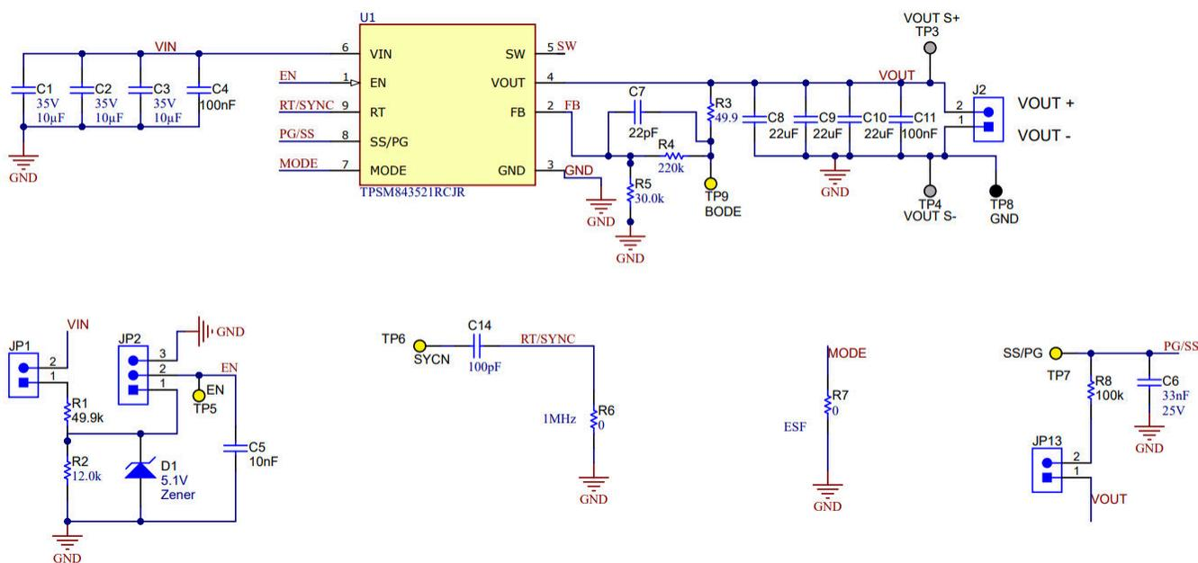
图 7-1. TPSM843521 5V 输出、5A 参考设计
