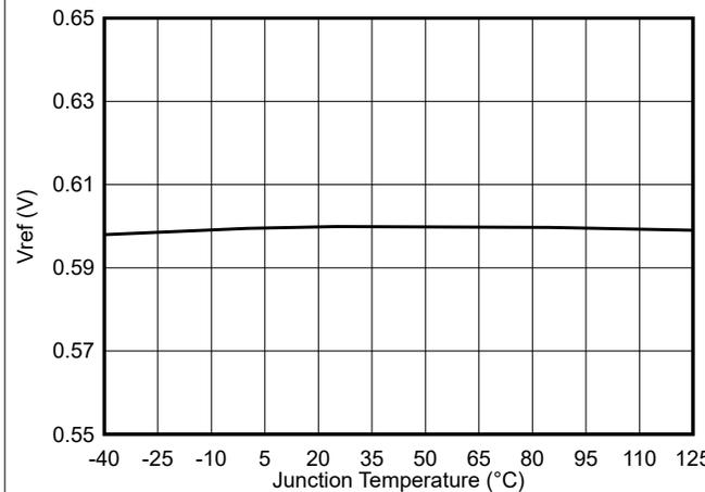
图 5-3. 反馈电压与结温间的关系
