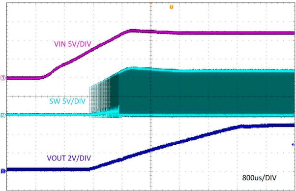
图 7-3. 相对于  $V_{IN}$ 、 $I_{OUT} = 3A$  的启动
