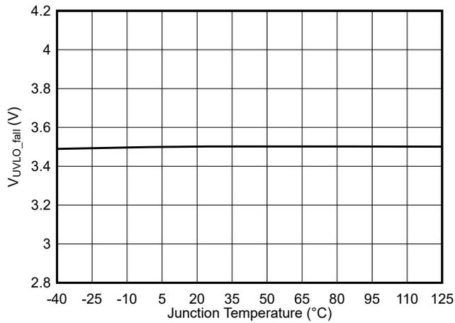
图 5-7.  $V_{IN}$  UVLO 下降阈值与结温间的关系
