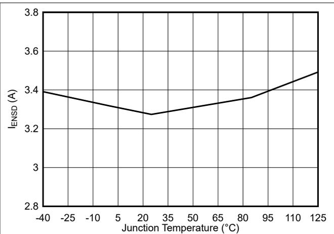
图 5-2. TPSM843521 关断电流与结温间的关系
