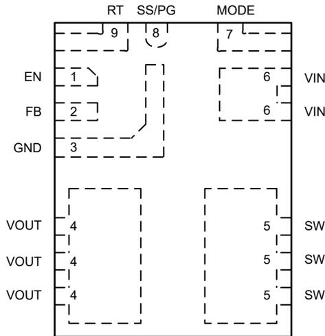
图 4-1.9 引脚 RCJ QFN-FCMOD, 3.3mm × 4.5mm 封装 (俯视图)
