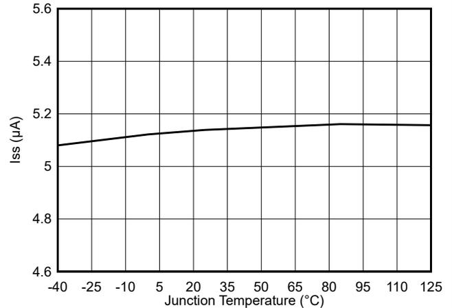
图 5-10. 软启动充电电流与结温间的关系
