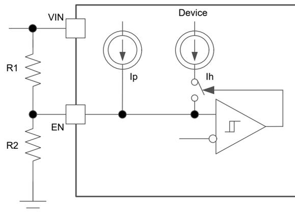
图 6-6. 可调节  $V_{IN}$  欠压锁定
