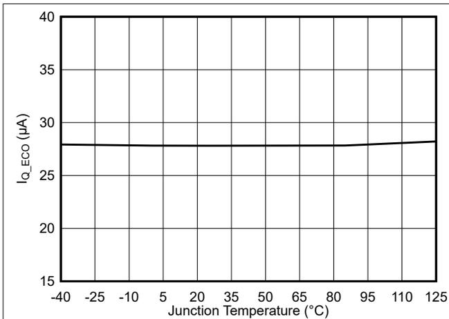
图 5-1. TPSM843521 静态电流 (PFM) 与结温间的关系
