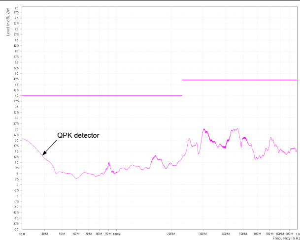
图 9-10. 符合 CISPR 32 B 类辐射发射限制 : 水平极化
