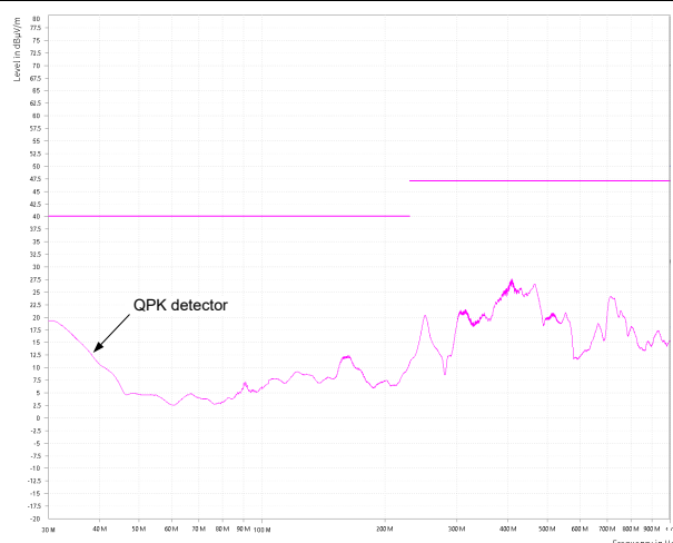
图 9-11. 符合 CISPR 32 B 类辐射发射限制 : 垂直极化
