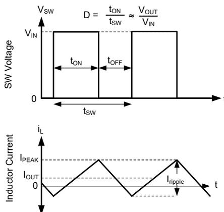
在 FPWM 模式下，即使  $I_{OUT}$  小于  $I_{ripple}$  的一半，也可实现连续导通 (CCM)。
