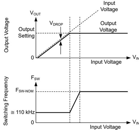
输出电压和频率与输入电压间的关系：如果输入电压和输出电压设置之间的差异很小，IC 会降低频率以保持稳压。如果输入电压过低，无法在大约 110kHz 的频率下提供所需的输出电压，则输入电压会跟踪输出电压。
