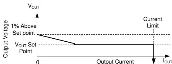
在自动模式下，一旦输出电流低于器件大概 1/10 的额定电流，输出电阻会增加，以便在降压转换器完全空载时输出电压为 1% 高电平。
