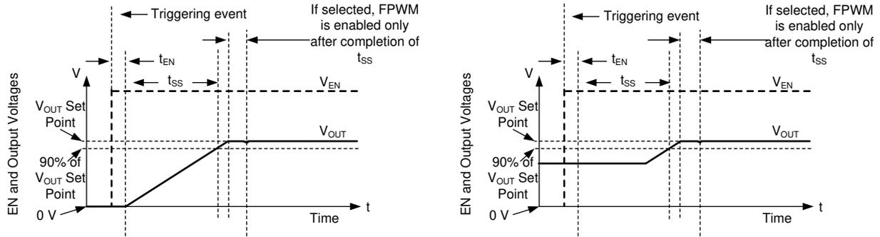
图 9-11. 带和不带预偏置电压的软启动/停止
