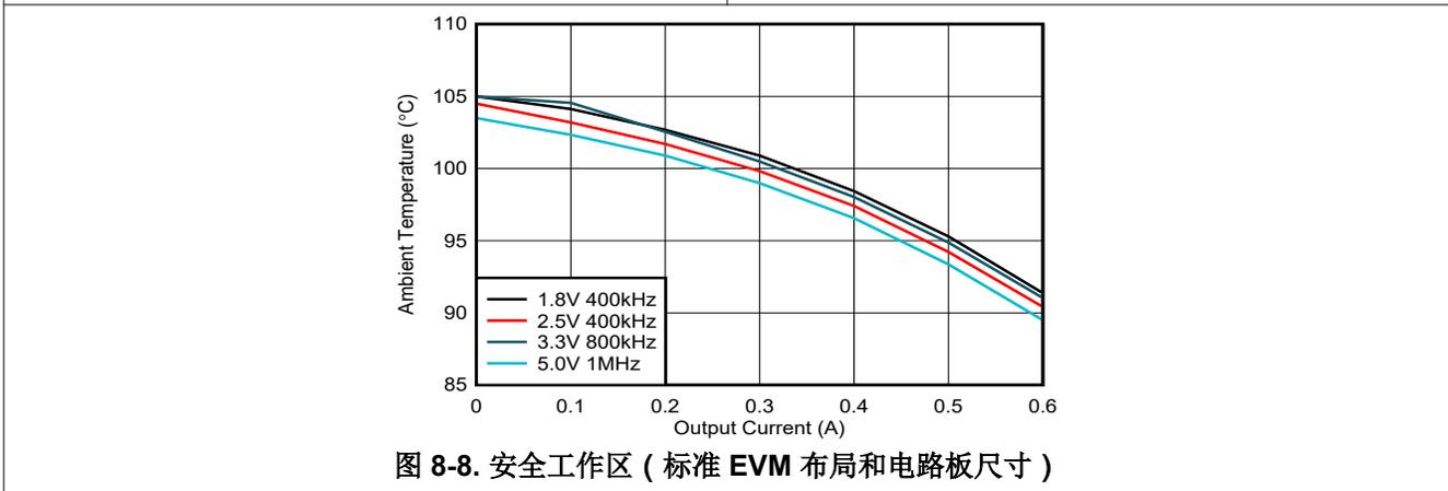
图 8-8. 安全工作区 (标准 EVM 布局和电路板尺寸)
