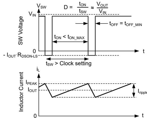
压降时的开关波形。电感器电流需要比正常时钟更长的时间才能达到所需的峰值。因此，频率会下降。该频率下降受到  $t_{\text{ON-MAX}}$  的限制。
