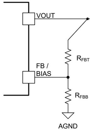
图 9-2. 为可调输出型号设置输出电压
