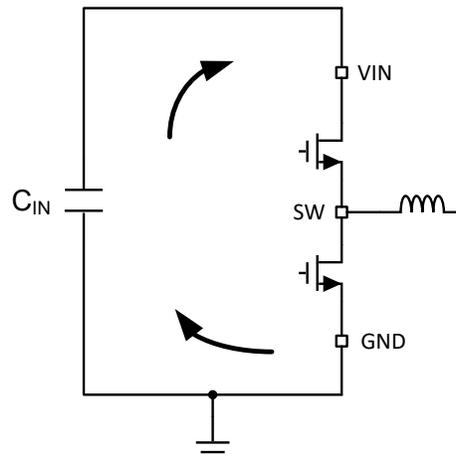
图 10-14. 具有快速边沿的电流环路
