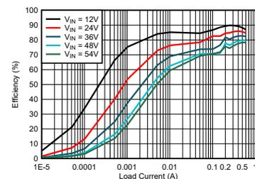
效率与输出电流间的关系 V<sub>OUT</sub> = 5V, F<sub>sw</sub> = 1MHz
