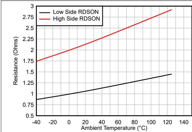
图 6-3. HSFET 和 LSFET  $R_{DSON}$  与温度间的关系
