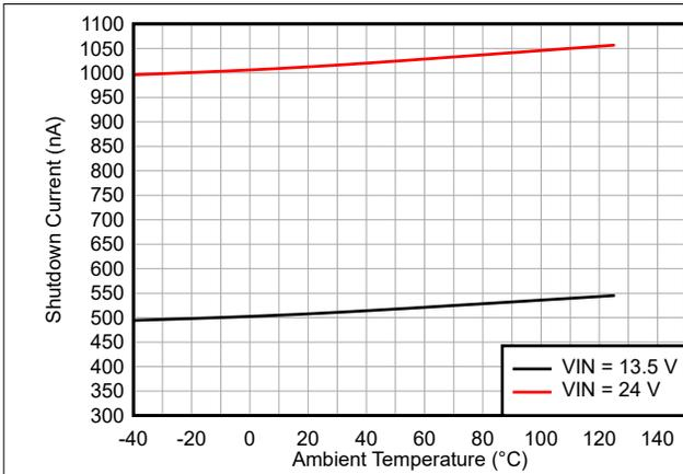
图 6-1. 关断电源电流与环境温度间的关系
