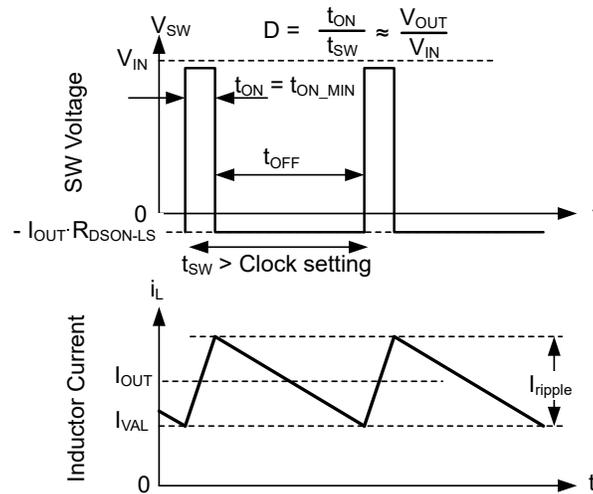
在谷值控制模式下，调节最小电感器电流，而不是峰值电感器电流。
