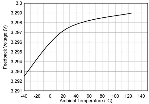
图 6-2. 3.3V 反馈电压与温度间的关系
