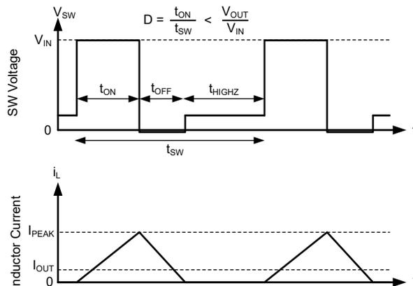
在自动模式下，一旦 SW 节点电流接近零，低侧器件就会关闭。因此，在运行二极管仿真时，一旦输出电流小于 CCM 模式中电感器纹波的一半，该器件就会以 DCM 模式运行。
