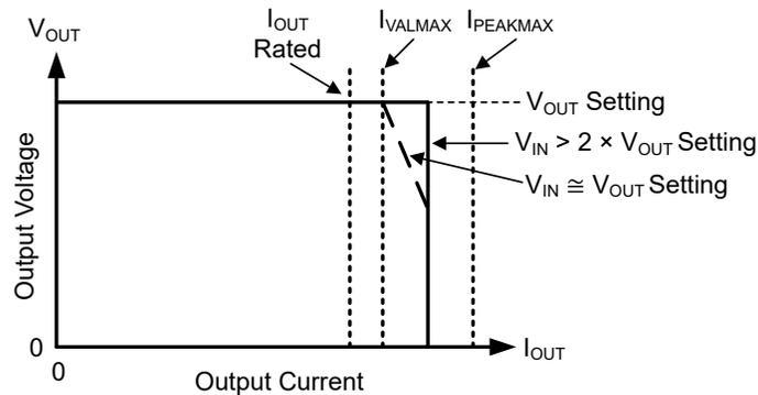
图 7-12. 输出电压与输出电流间的关系
