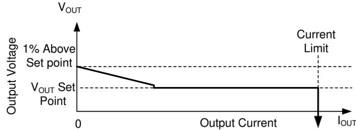
在自动模式下, 一旦输出电流低于于器件大概 1/10 的额定电流, 输出电阻会增加, 以便在降压转换器完全空载时输出电压为 1% 高电平。
