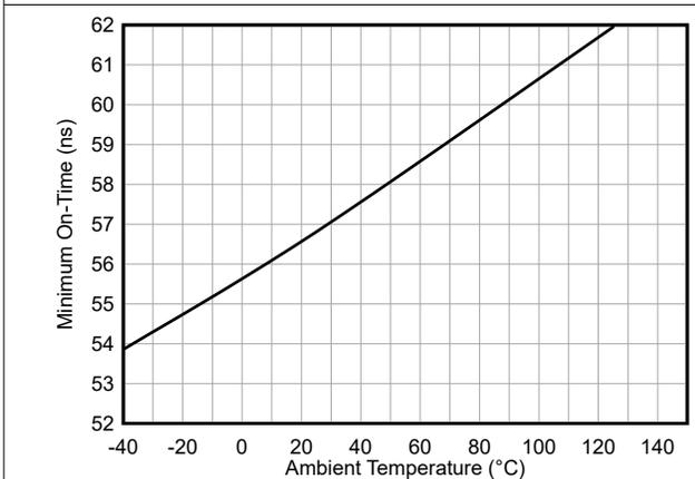
图 6-5. 最短导通时间与温度间的关系
