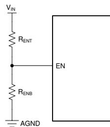
图 7-2.  $V_{IN}$  欠压锁定
