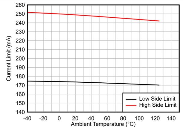
图 6-6. 高侧 (峰值) 和低侧谷值电流限制
