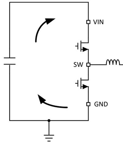
图 8-15. 具有快速边沿的电流环路
