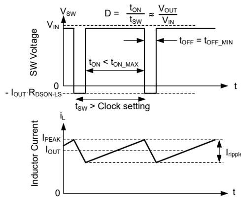
压降时的开关波形。电感器电流需要比正常时钟更长的时间才能达到所需的峰值。因此，频率会下降。该频率下降受到  $t_{ON\_MAX}$  的限制。
