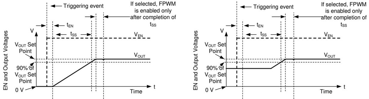
图 7-9. 带和不带预偏置电压的软启动
