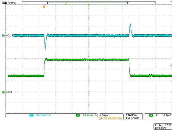
$V_{IN} = 24V$      $V_{OUT} = 3.3V$  (固定值)    2.2MHz
