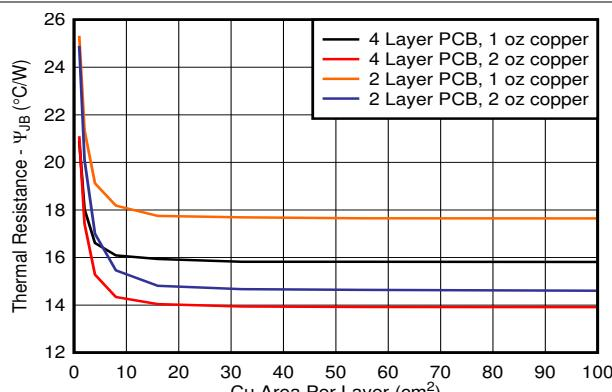
图 7-3.  $\psi_{JB}$  vs Copper Area 2s2p DRB Package
