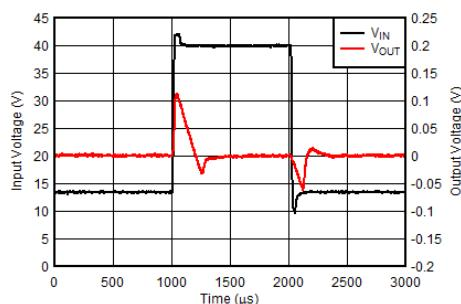
线路瞬态响应 ( $V_{\text{IN}}$  压摆率  $3\text{V}/\mu\text{s}$ )
