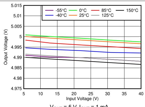
图 5-4. Line Regulation vs  $V_{IN}$
