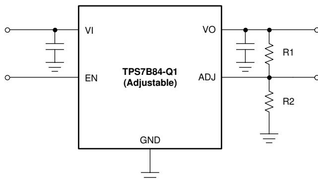
图 7-7. Typical Application Schematic for the TPS7B84-Q1
