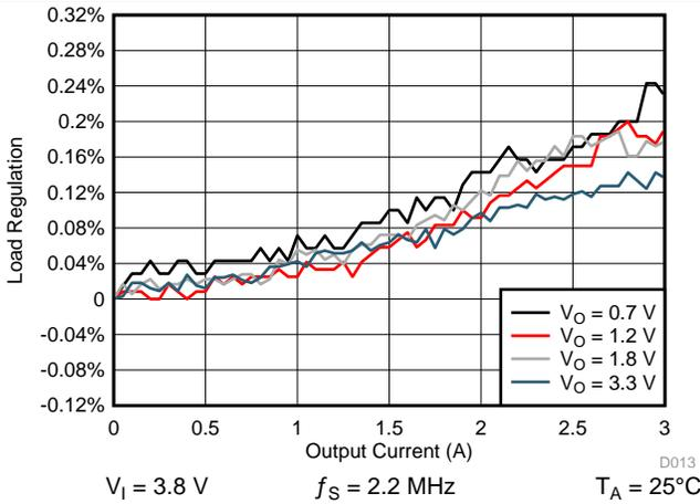
图 4-12. SMPS Load Regulation for SMPS3, PWM Mode
