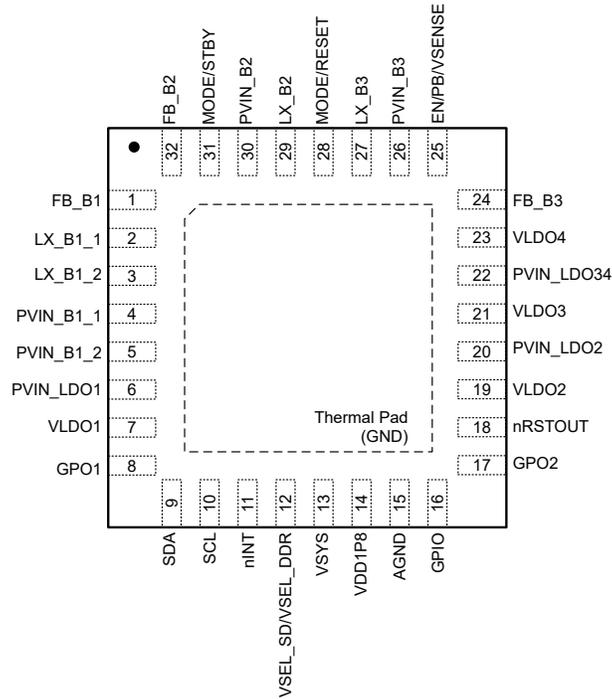
图 4-1. RHB 封装，32 引脚 QFN (顶视图)
