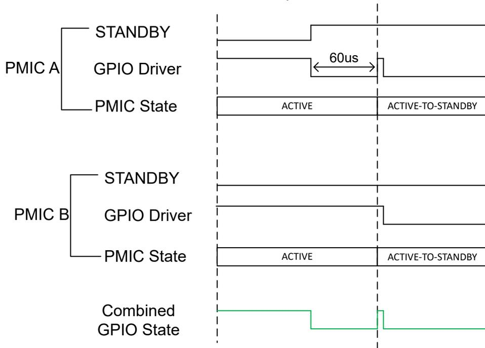
图 6-14. 转换到待机/OFF 请求/冷复位前同步
