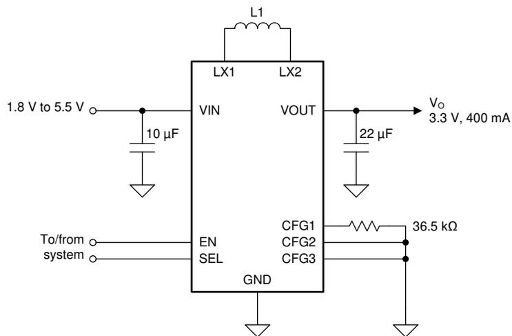
图 8-1. 3.3 V<sub>OUT</sub> Typical Application
