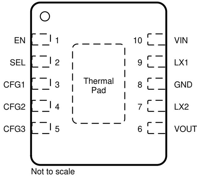
图 5-1. 10-Pin WSON DSK Package (Top View)
