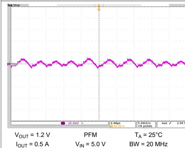
图 10-46. Output Voltage Ripple
