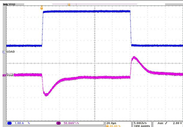
图 10-25. Load Transient Response
