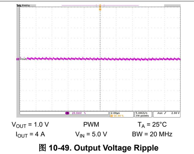
图 10-49. Output Voltage Ripple
