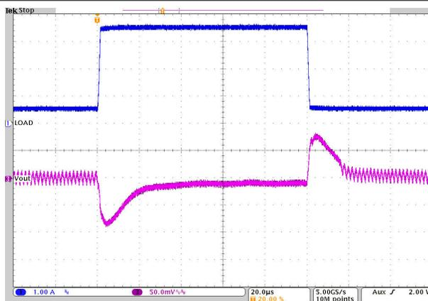
图 10-24. Load Transient Response
