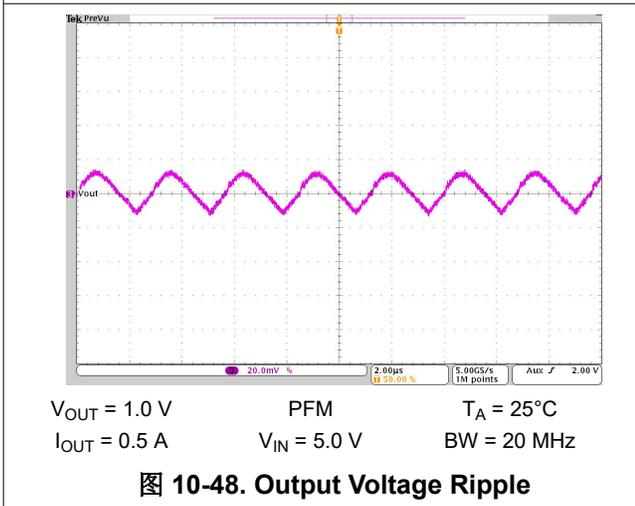
图 10-48. Output Voltage Ripple
