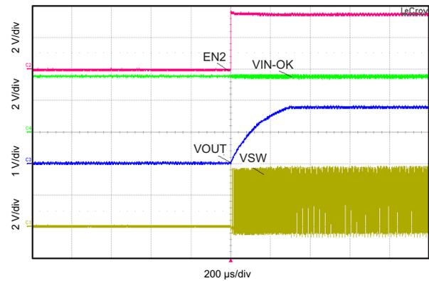
Figure 73. Standby-Mode Startup Behavior
