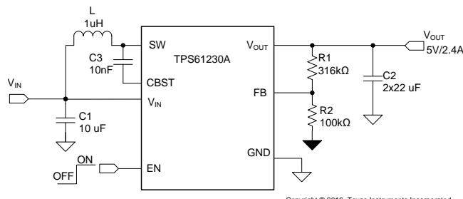
典型运行频率为 1.15MHz，因此可使用小型电感和电容实现小型封装尺寸。TPS61230A 通过一个外部电阻分压器提供可调节输出电压。
