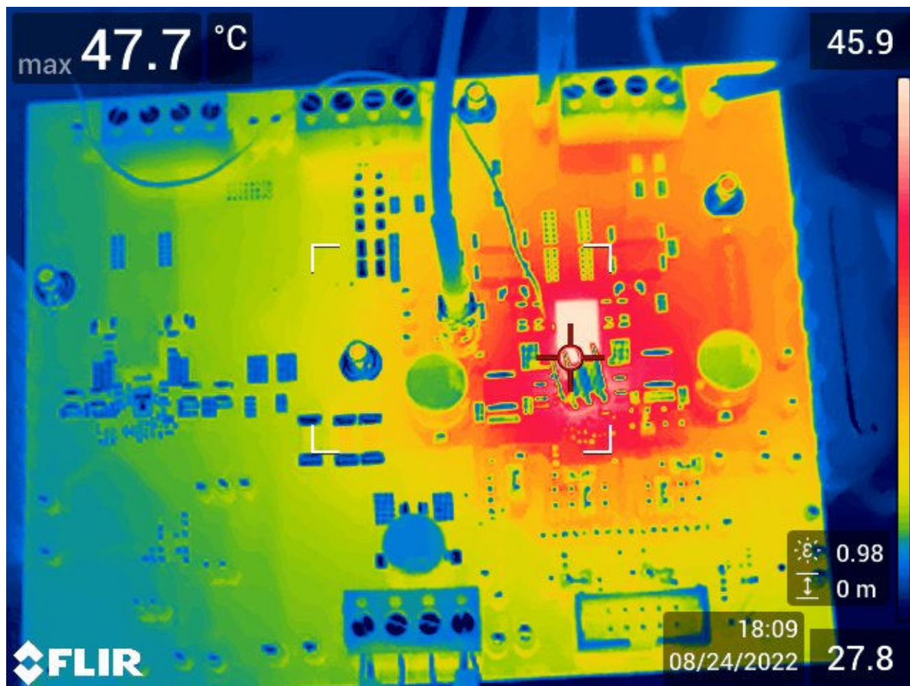
图 7-24. 25^\circ\text{C} 环境温度下的热图像
