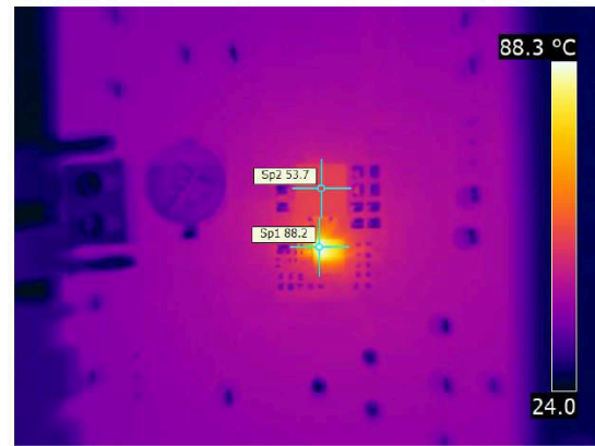
图 6-14. Thermal Image at 14-A Output Current
