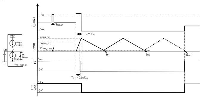
图 8-9. Overcurrent Protection With Auto-Retry
