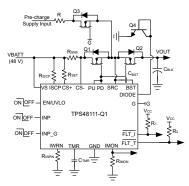
用于直流/直流转换器的断路器
