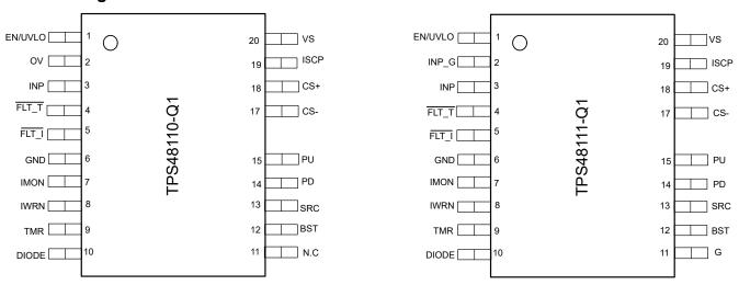
图 5-1. DGX Package, 19-Pin VSSOP (Top View)
