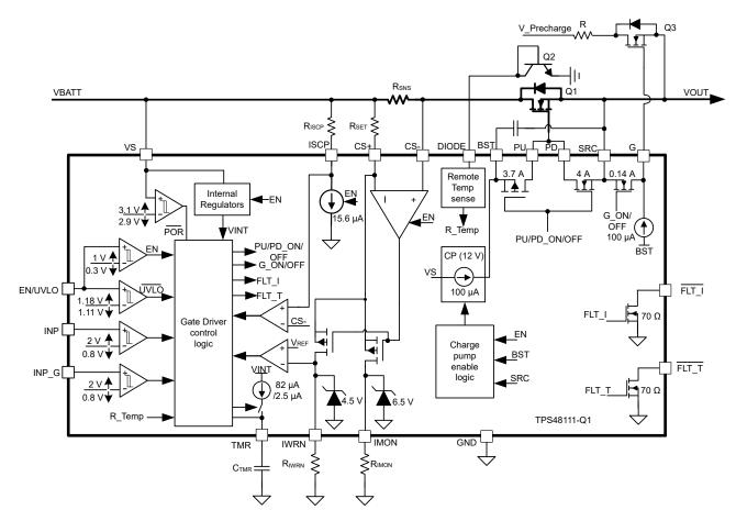
图 8-2. TPS48111-Q1 Functional Block Diagram
