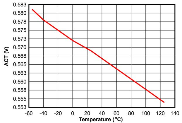
图 6-2. ACT 逻辑低阈值电压与温度间的关系
