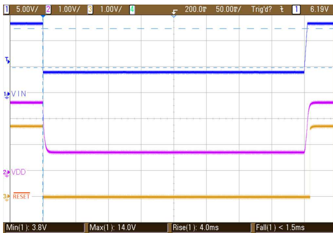
图 50. TPS3840-Q1 Warm-Start Test Pulse
