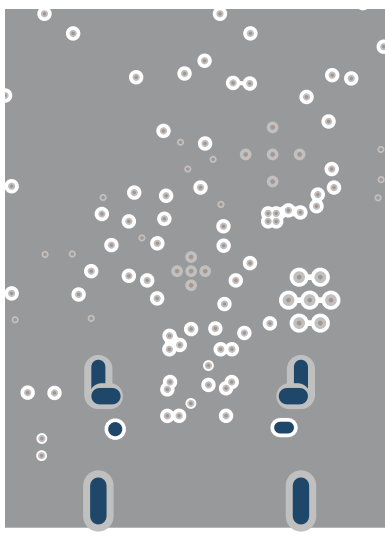
图 8-28. TPS26750 PCB 布局 - GND 层 2
