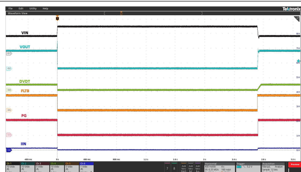
TPS25984B0 型号。C OUT = 8mF, C DVDT = 33nF 图 6-19. 容性负载下的浪涌电流控制
