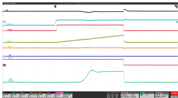
图 8-8. 上电至短路: V_{IN} = 12V , EN/UVLO 从 0V 阶跃至 3V, R_{REF} = 40.2k\Omega , 每个器件的 R_{ILIM} = 442\Omega , 且 OUT 短接至 GND
