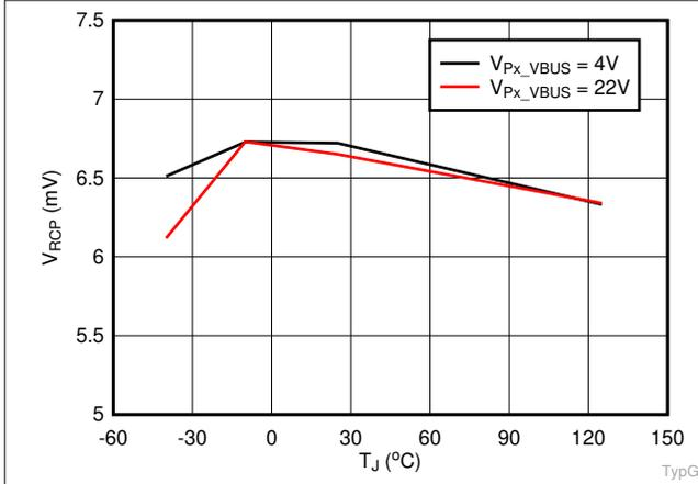
图 6-1. V<sub>RCP</sub> vs. Temperature
