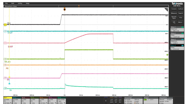
图 6-20. 过流保护响应 (断路器)
