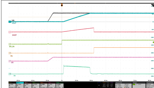
图 8-4. V_{IN} 从 0V 斜升至 54V
