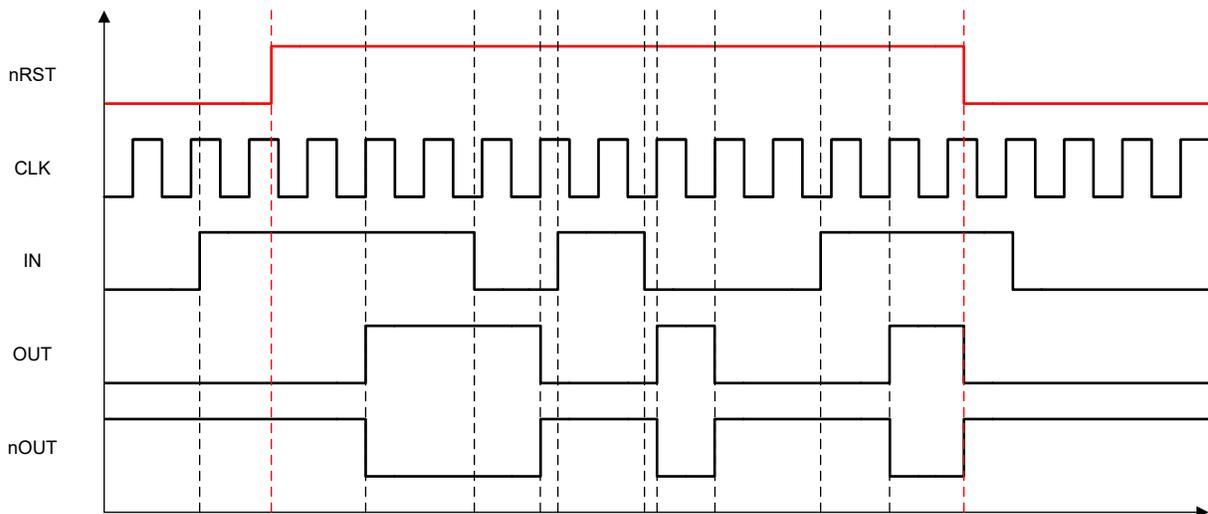
图 7-7. 管道延迟宏单元时序示例 (延迟 = 2)
