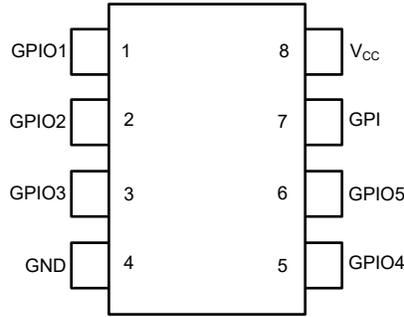
图 4-1. DRL 封装 8 引脚 SOT-5X3 ( 顶视图 )
