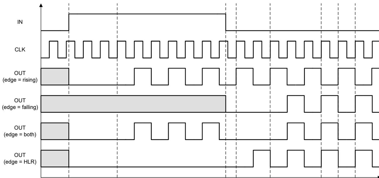
图 7-14. 计数器输出时序示例 (DATA = 1)
