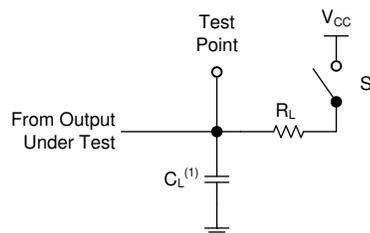
(1)  $C_L$  包括探头和测试夹具电容。
