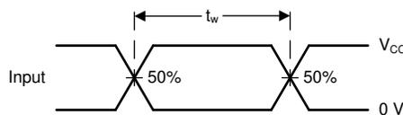
图 6-4. 电压波形，脉冲持续时间
