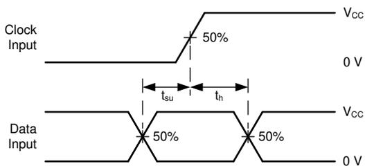
图 6-5. 电压波形，设置和保持时间
