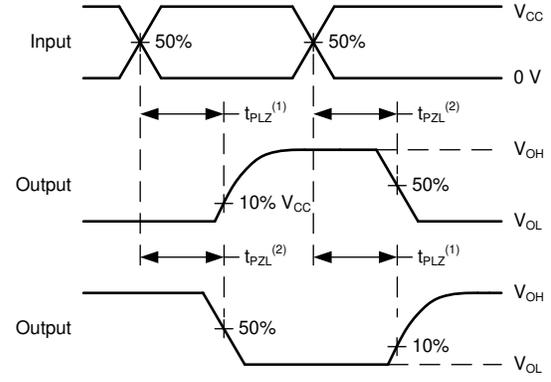
(1)  $t_{PLZ}$  和  $t_{PZL}$  之间的较大者与  $t_{pd}$  相同。
