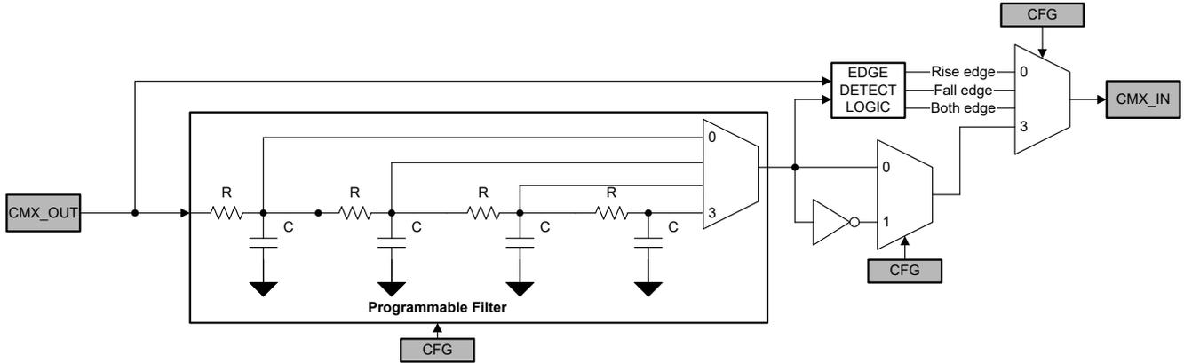
图 7-17. 可编程滤波器和边沿检测器方框图
