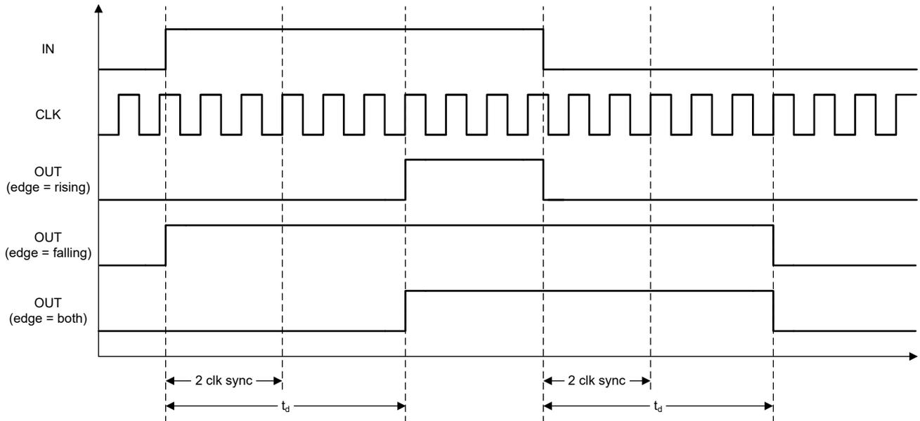
图 7-12. 延迟输出时序示例 (DATA = 3)
