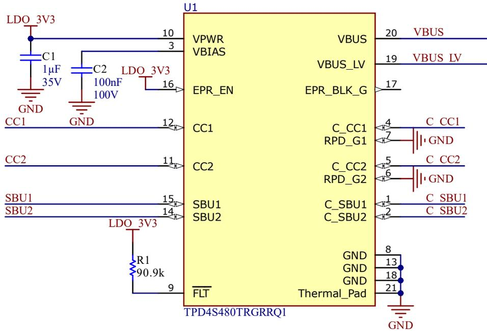
图 7-2. TPD4S480-Q1 无 FET 的非电池无电
