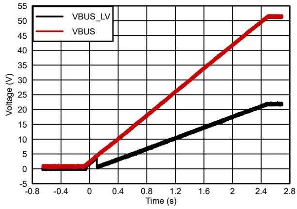
图 5-9. EPR\_EN 为高电平时的 VBUS 扫描
