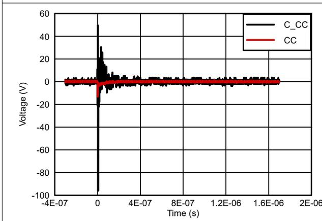
图 5-7. CC IEC 61000-4-2 -8kV 响应波形
