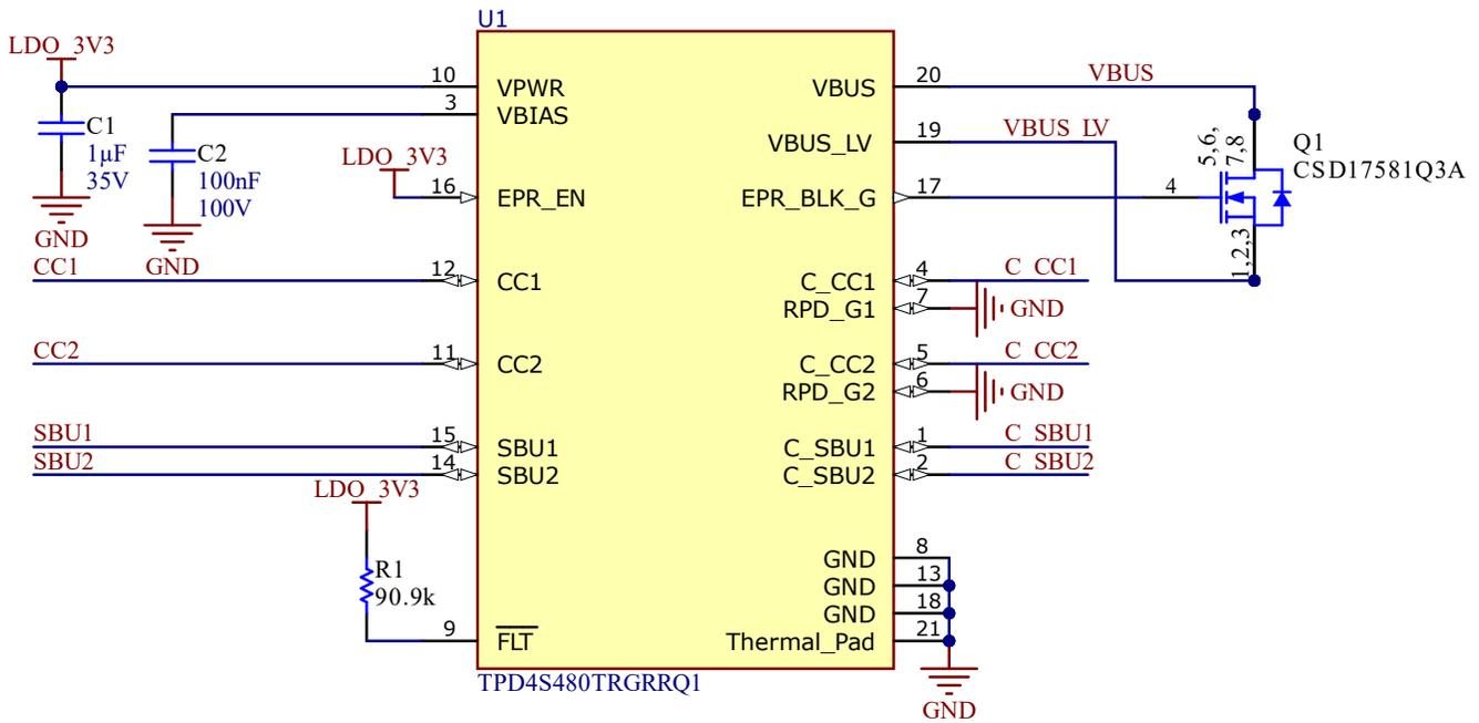
图 7-3. TPD4S480-Q1 带 FET 的非电池无电
