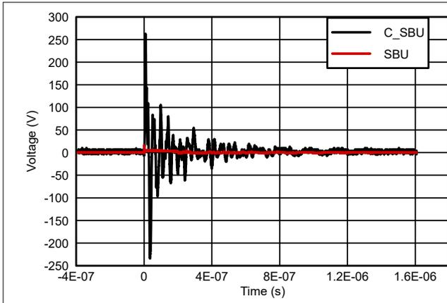
图 5-3. SBU IEC 61000-4-2 4kV 响应波形
