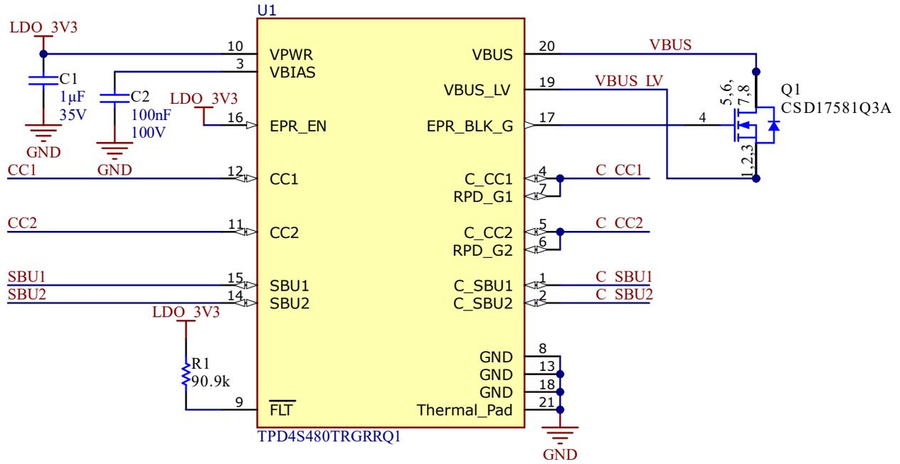
图 7-4. TPD4S480-Q1 带 FET 的电池无电
