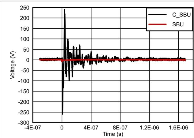
图 5-4. SBU IEC 61000-4-2 -4kV 响应波形
