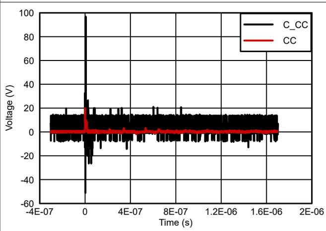
图 5-6. CC IEC 61000-4-2 8kV 响应波形
