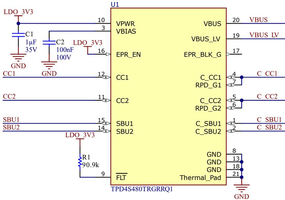
图 7-1. TPD4S480-Q1 无 FET 的电池无电
