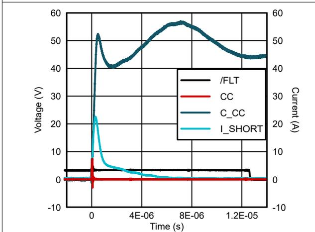
图 5-5. CC 短接至  $V_{BUS}$  48V
