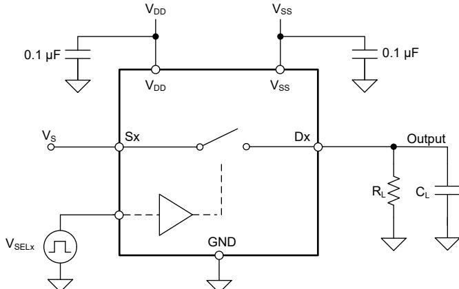
图 6-4. Turn-On and Turn-Off Time Measurement Setup
