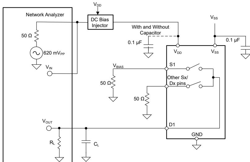
图 6-12. AC PSRR Measurement Setup
