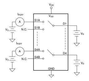
图 30. IPOFF Leakage Measurement Setup
