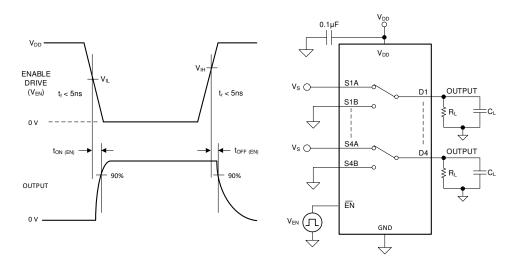
图 32. t<sub>ON (EN)</sub> and t<sub>OFF (EN)</sub> Time Measurement Setup
