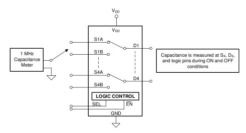
图 38. Capacitance Measurement Setup
