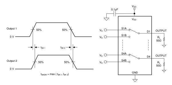
图 36. Skew Measurement Setup
