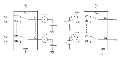
图 29. On-Leakage Measurement Setup
