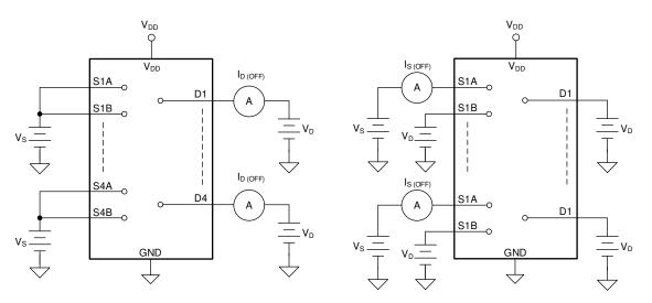
图 28. Off-Leakage Measurement Setup
