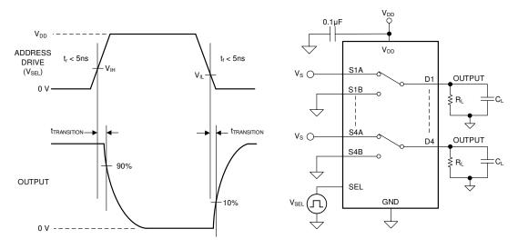
图 31. Transition-Time Measurement Setup
