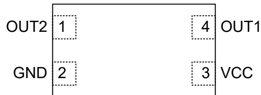
图 5-1. ZFC 封装 4 引脚 X1LGA 顶视图
