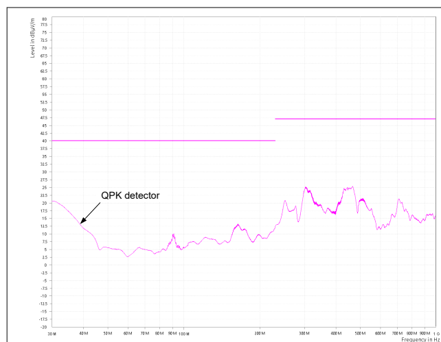
图 9-8. 符合 CISPR 32 B 类辐射发射限制：水平极性
