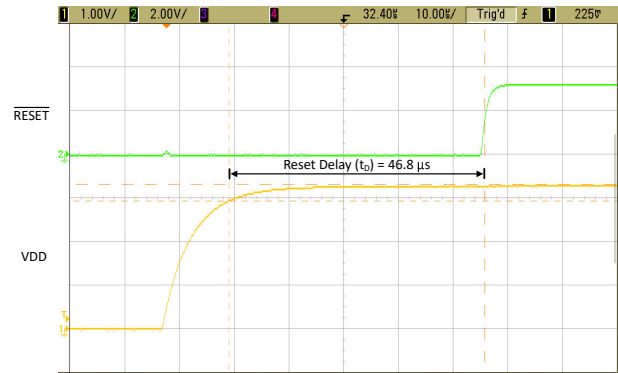
图 9-4. TLV841EVM RESET Time Delay ( t_D )
