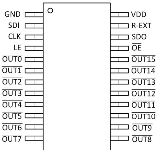
图 5-1. DBQ Package 24-Pin SSOP Top View
