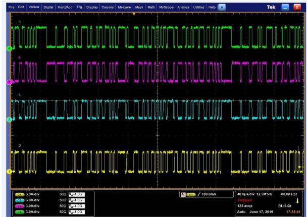
THVD2410 V_{CC} = 3.3V R_L = 50\Omega 500kbps 速率下的随机 (PRBS7) 数据
