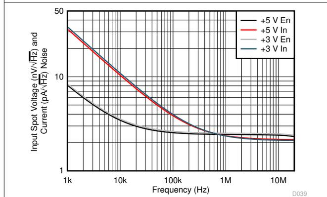
图 6-39. 输入点噪声随频率变化的情况
