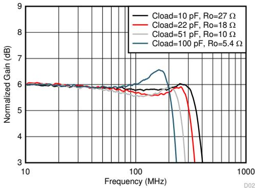
负载上  $100mV_{pp}$ ， $A_v = 2$ （请参阅图 7-11），在  $Cloud$  之前的输出端添加两个串联  $R_o$
