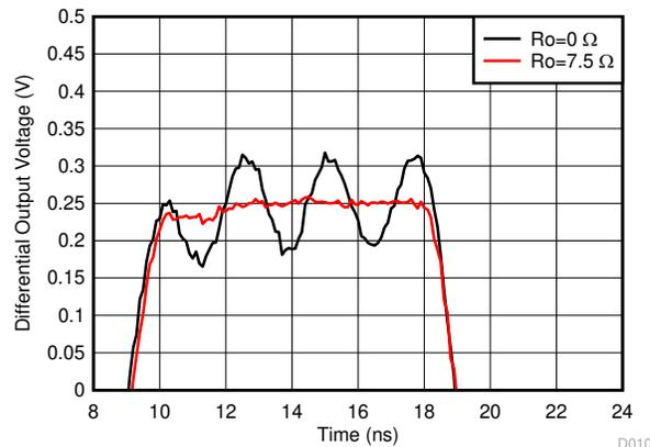
$G = 5V/V$ ，500mV<sub>PP</sub> 输出连接到 22pF Load，请参阅图 7-11 和表 8-1
