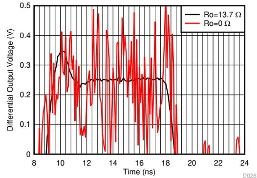
$500mV_{pp}$  输出连接到  $22pF$   $Cloud$ ，请参阅图 7-11（ $V_{s+} = 3V$ ， $V_{ocm} = 1.5V$ ）
