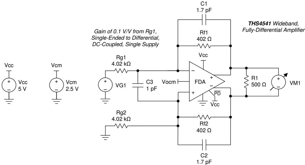
图 9-2. 使用 THS4541 的补偿衰减器电路
