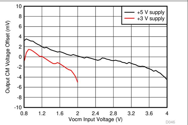
37 个器件的平均  $V_{ocm}$  输出偏移，标准偏差  $< 2.5mV$ ，请参阅图 7-3
