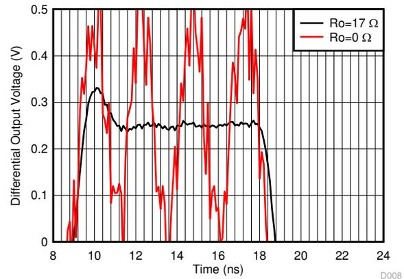
$A_v = 2$ ，500mV<sub>PP</sub> 输出连接到 22pF Load，请参阅图 7-11
