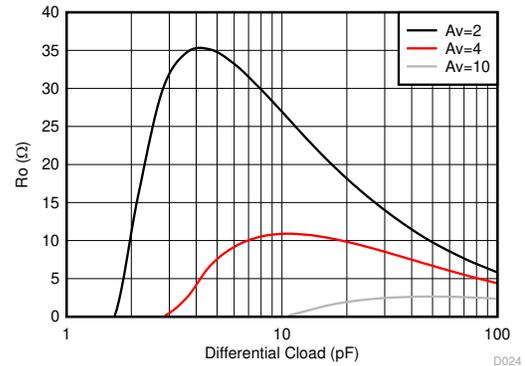
输出端的两个  $R_o$  连接到差分  $Cloud$ （与  $500\Omega$  电阻并联），请参阅图 7-11 和表 8-1
