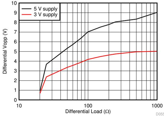
最大差分输出摆幅，1/2  $V_{S+}$  时的  $V_{ocm}$
