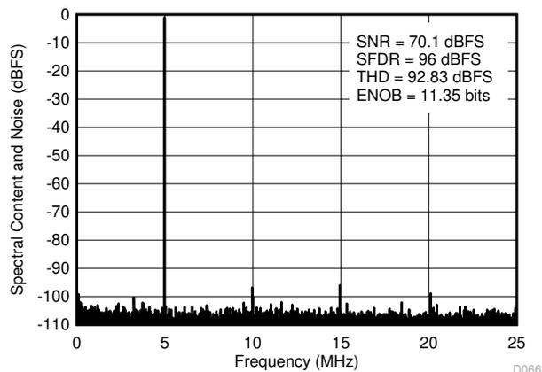
图 9-5. 图 9-4 中增益为 2 的接口的 5MHz FFT、50MSPS 测试
