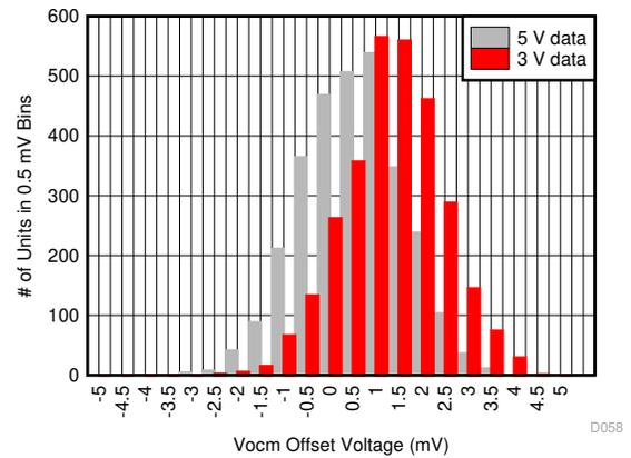
输入驱动  $1/2 V_{S+}$ ，3 个批次，总共 2962 个器件
