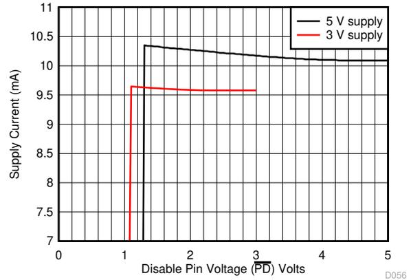
图 6-56. 电源电流与  $\overline{PD}$  电压之间的关系
