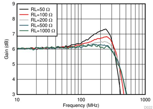
$V_{out} = 100mV_{pp}$ ，请参阅图 7-1（ $R_{load}$  经过调节）
