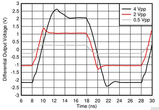
$50MHz$  输入， $0.3ns$  输入边沿速率，单端输入至差分输出，直流耦合，请参阅图 7-3
