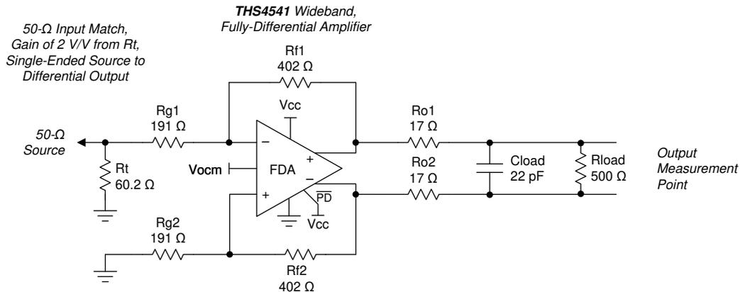
图 7-11. 在驱动容性负载时包含  $R_o$
