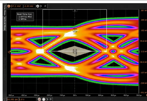
图 7-6. TP3_EQ 处带 TDP2004-Q1 用于信号调节的 DP 2.1 Tx 符合性眼图
